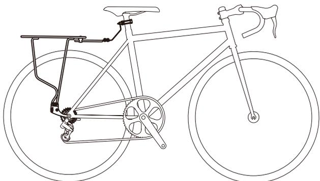
後輪車軸のクイックリリースとシートポストをクランプで保持する方式のリアキャリアです。
