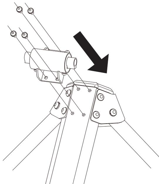
ブーストハブ用前フォーク受けを 4 本のボルトを締め付けて取り付けます。
